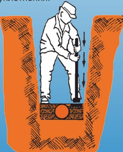
Защитный слой трубы выполняется из сыпучего песка без камней. Этот слой должен быть тщательно утрамбован по обеим сторонам трубопровода. Засыпку и трамбовку грунта в защитной зоне трубопровода необходимо выполнять слоями с одновременным удалением опалубки. Толщина утрамбованного слоя не должна превышать одной трети диаметра трубы.
