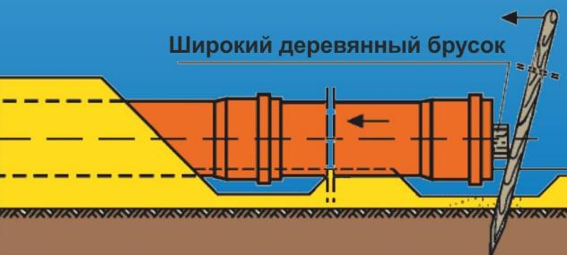
ния безрастворного конца трубы или фасонные части в раструб другой трубы и последующего проведения испытаний. Форма и размеры монтажного приямка должны исключить возможность проникновения грунта внутрь раструба.
