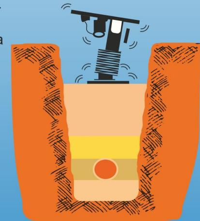
полнять механически только тогда, когда толщина начального заполнения над трубой более 300 мм. Эта процедура выполняется до полного заполнения траншеи или до момента образования слоя толщиной минимум 90 см над верхом трубы. Остальное заполнение траншеи уплотняется при помощи экскаватора. Засыпка трубопровода в траншее состоит из двух слоёв:
